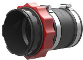
Con la cubierta del sistema HSI150 MA se pueden conectar canales de cables lisos y corrugados con un diámetro exterior de 110, 125 o 160 mm. La conexión de tubería se realiza mediante un casquillo de goma elástico y estable, que se presiona contra la cubierta del sistema y el canal de cables con correas de sujeción de acero inoxidable.
