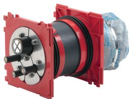
La protección contra incendios HSS150 HSI150 para paredes es una protección contra incendios estanca al gas y al agua con clase de resistencia al fuego S90 según la norma DIN 4102-9 para el montaje en el sistema HSI150 K2. El sistema se sella mediante una cubierta del sistema. La protección está homologada para cables de todo tipo en paredes y para la creación de paquetes con HSI150 hasta 2x6.
