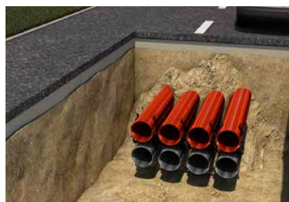
Minimale Verlegetiefe von Kabelschutzschläuchen bei Schwerlastverkehr SLW60
